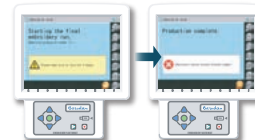
Number of pieces control function in FDR3 生产预定件数控制功能
